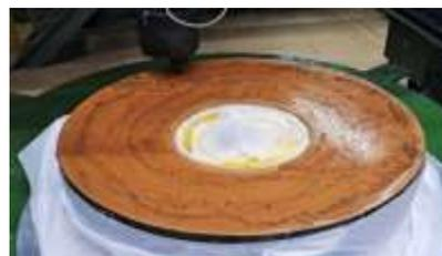
Рис. 5. Доводка зеркала из карбида кремния на станке с программным управлением
