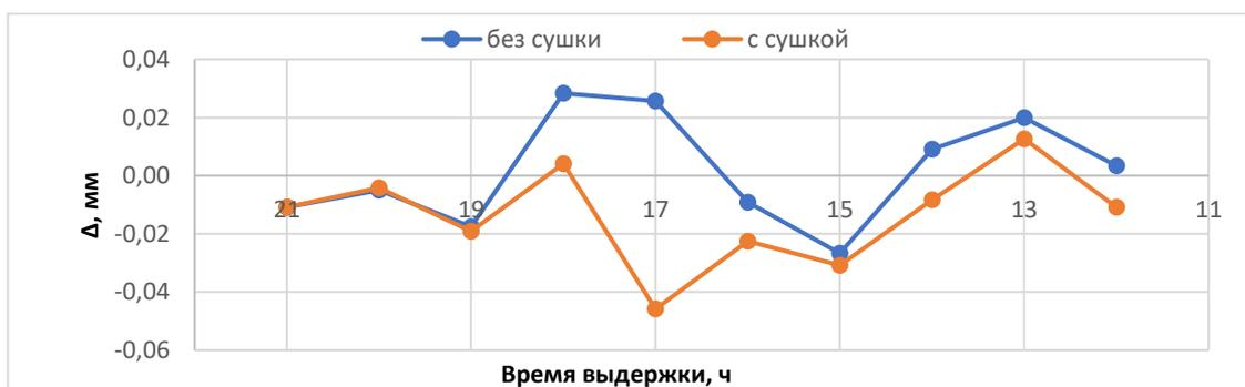
Рис. 3. Изменение толщины клеевого шва, измеренной сразу после разборки приспособления и через 24 ч после разборки, в зависимости от времени выдержки под давлением и от наличия сушки
