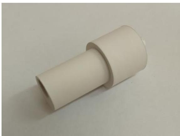
Рис. 1. Чувствительный элемент после предварительного спекания
