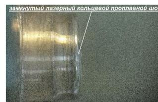
Рис. 9. Внешний вид лазерного проплавного шва
