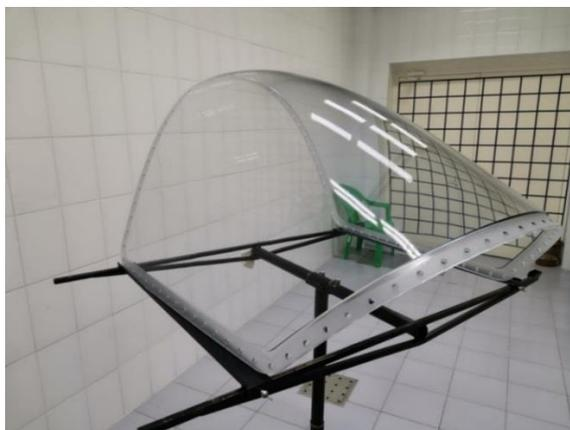
Рис.1. Остекление фонаря самолета с модифицированной поверхностью
