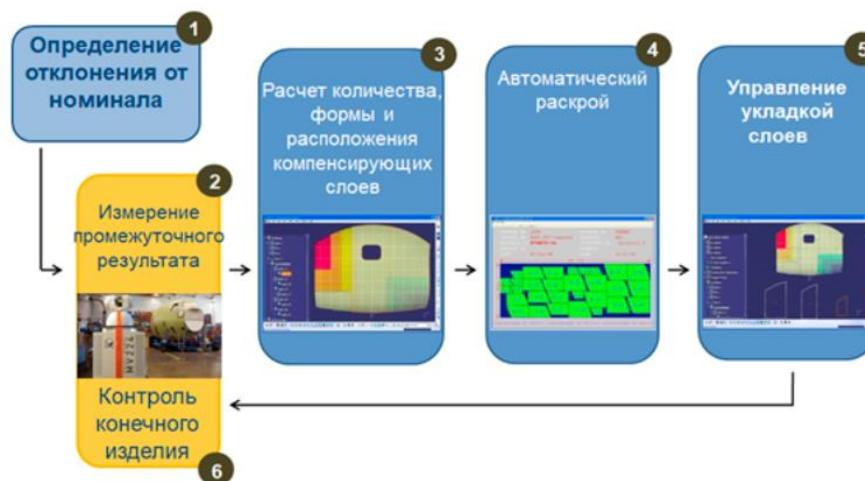
Рис. 1. Принципиальная схема работы комплекса по выкладке в точный размер
