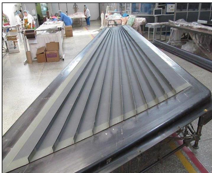
Рис. 1. Оснастка с отформованной стрингерной панелью
