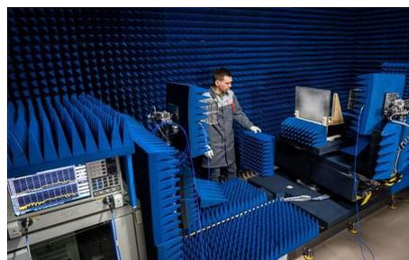
Рис. 1. Специальный комплекс для измерения радиотехнических характеристик конструкций в диапазоне 4-40 ГГц
