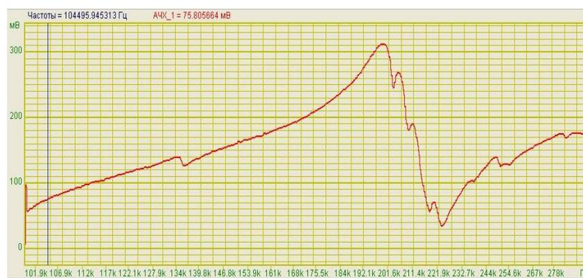
Рис. 3. Вид амплитудно-частотной характеристики бракованного пьезоэлемента
