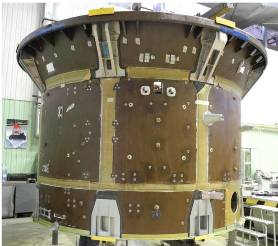
Рис. 1. Корпус двигательного отсека ПТТК НП «Орел»
