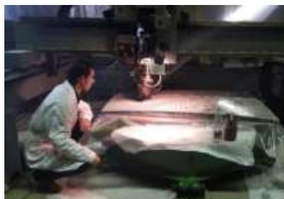
Рис. 3. Доводка матрицы размером 1,6 м с асферичностью до 20 мм из астроситалла для проекта космического телескопа «Миллиметрон» с зеркалом 10 м из углепластика
