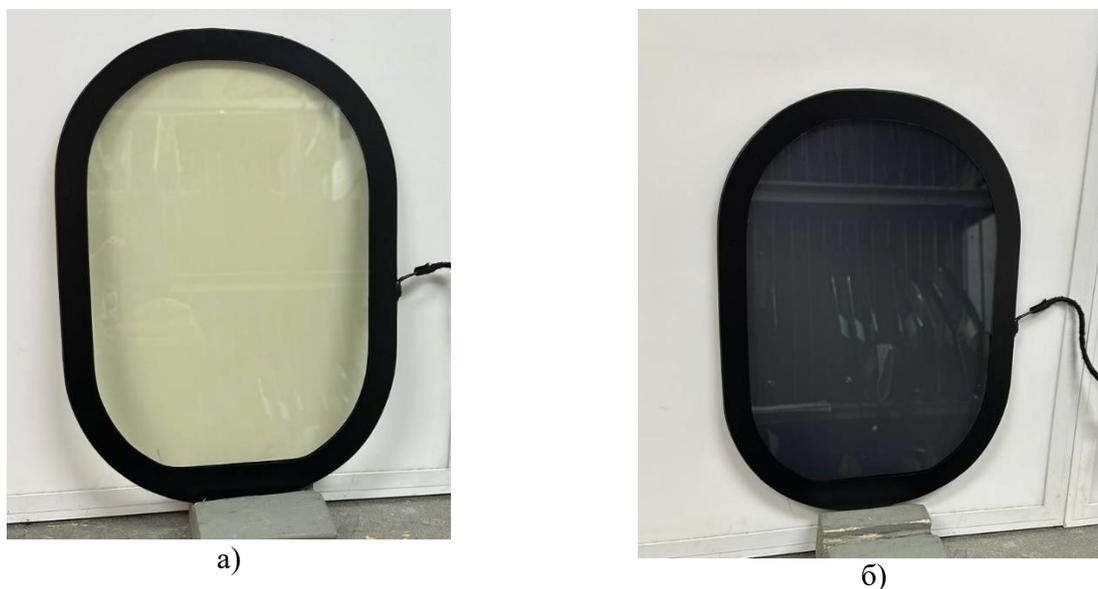
Рис. 1. Умное ЭХУ: а) в неокрашенном состоянии и б) в окрашенном состоянии
