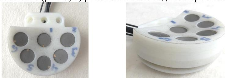
Рис. 2. Блок ультразвуковых преобразователей
