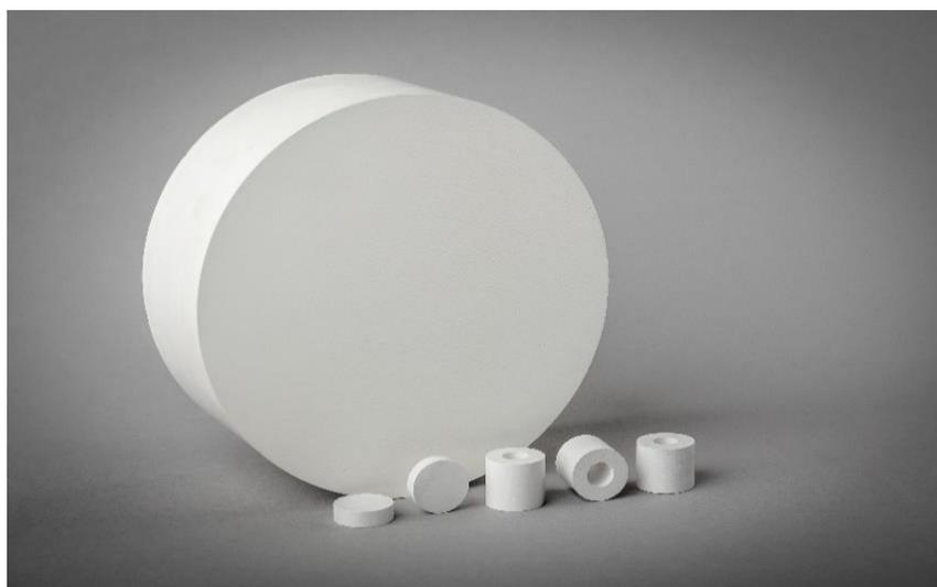
Рис. 2. Внешний вид заготовок и изделий из BN
