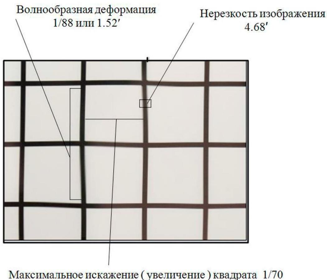
Рис. 1. Максимальное значение волнообразной деформации, искажения (увеличение) квадрата и нерезкости изображения
