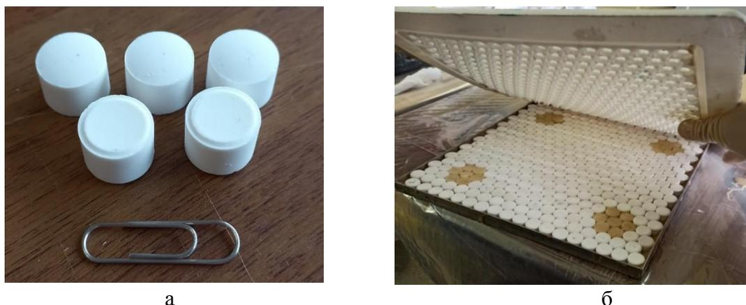
Рис. 1. Керамические бронезлементы (а) и сборка керамокомпозитной бронепанели (б)
