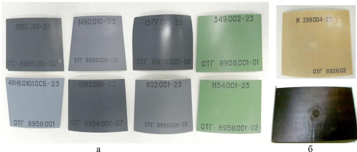
Рис. 4. Общий вид контрольных образцов: а) керамических, б) из ПКМ
