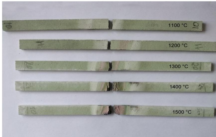
Рис. 2. Образцы композиционного материала на основе хромальмофосфатного связующего и кварцевой ткани после нагрева при механических испытаниях на растяжение
