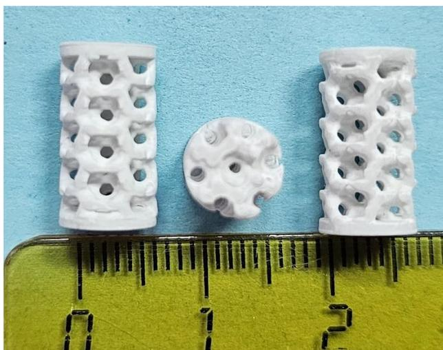
Рис. 1. Образец материала из фосфата магния со структурой Кельвина, полученный 3D-печатью
