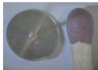
Рис. 6. ТВЭ, изготовленный электроразрядным способом
