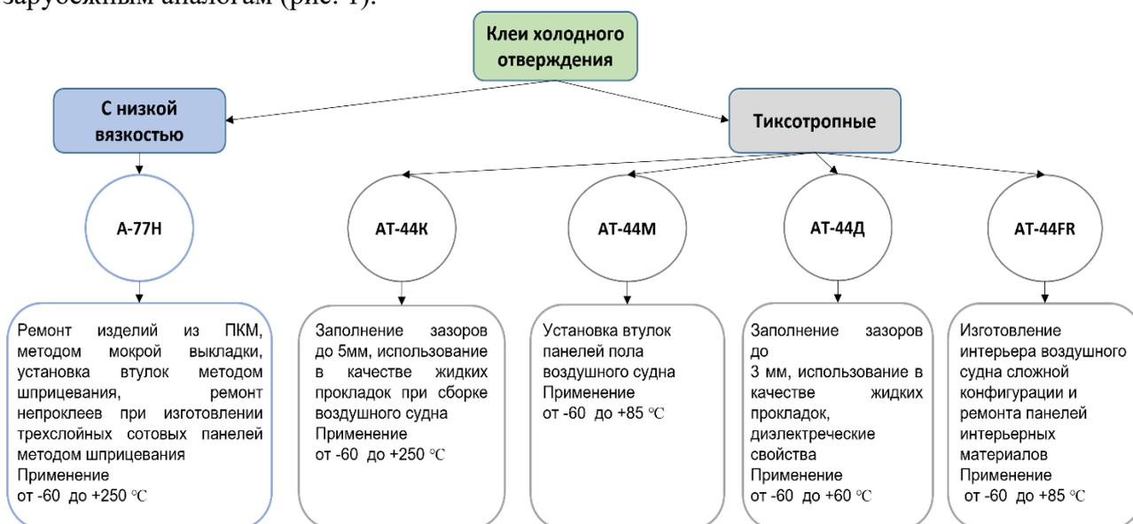
Рис. 1. Семейство эпоксидных клеев холодного отверждения ООО «ИТЕКМА»
