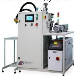
Рис. 5. Инжекционная машина с порошковым отвердителем «РЕАКТОР» 2СПК(М)
