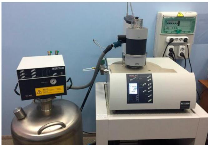
Рис. 1. Термомеханический анализатор ТМА F3 Hyperion
