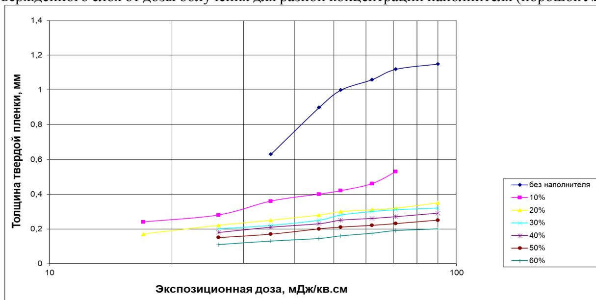
Рис. 1 Зависимости толщины отвержденной пленки  $h$  (мм) от экспозиционной дозы лазерного излучения ( $\lambda=405$  нм)  $E$  (мДж/см<sup>2</sup>) с разной концентрацией (мас. %) наполнителя
