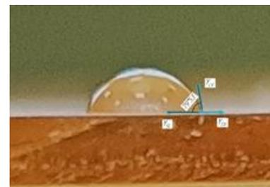
Рис. 6. Краевой угол смачивания водой
