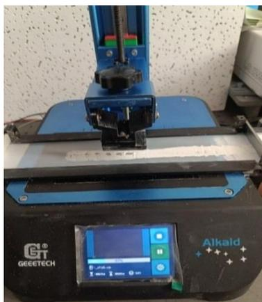
Рис. 1. Модифицированный LCD 3D-принтер для изготовления полимер-керамических изделий
