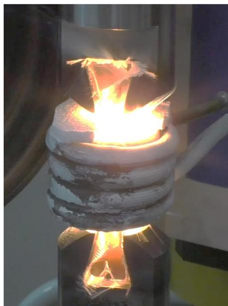
Рис. 3. Механические испытания на растяжение образца диборида циркония при нагреве до 1800 °С
