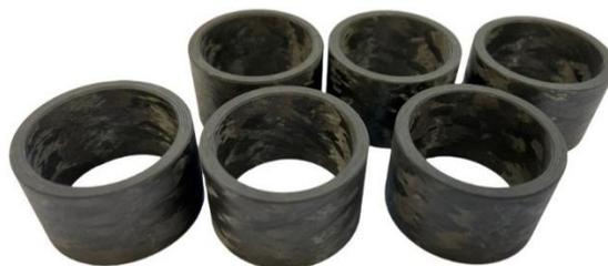
Рис. 3. Фотография вкладышей (габаритные размеры вкладышей: внешний диаметр 34 мм, внутренний диаметр 28,1 мм, высота 22 мм) из материала ВУКМ 1 для запорной арматуры
