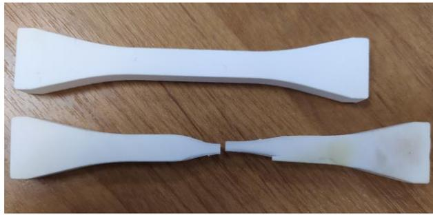
Рис. 1. Образцы кварцевой керамики после нагрева до 1500 °С при механических испытаниях на растяжение
