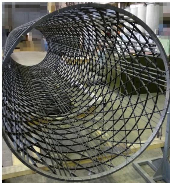
Рис. 1. Анизотридная структура силового корпуса космического аппарата
