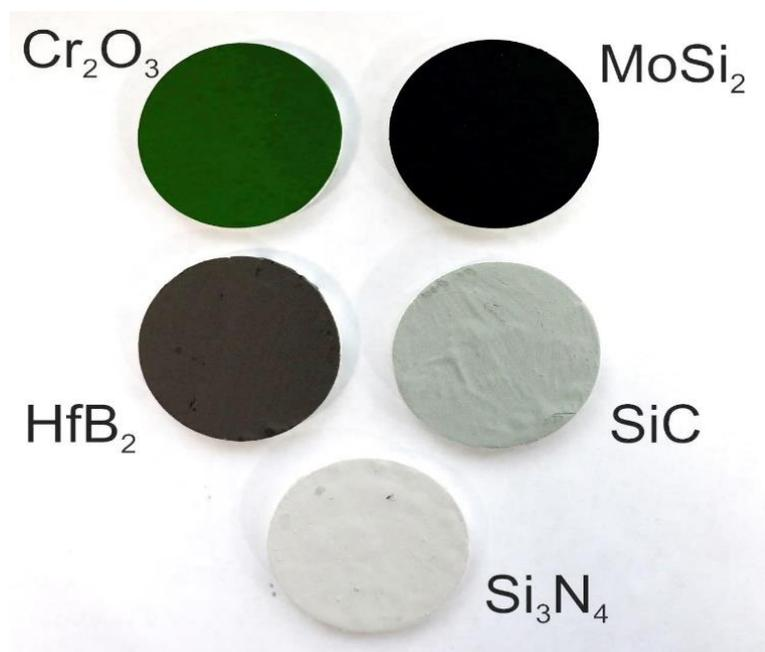
Рис. 1. Внешний вид керамических образцов после нанесения высокотемпературных поглощающих покрытий
