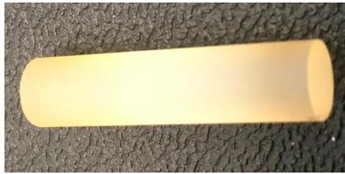
Рис. 2. Керн из ситалла СО-115М
