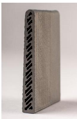
Рис. 1. Элемент кромки крыла с внутренними каналами охлаждения, полученный аддитивным методом экструзии материала
