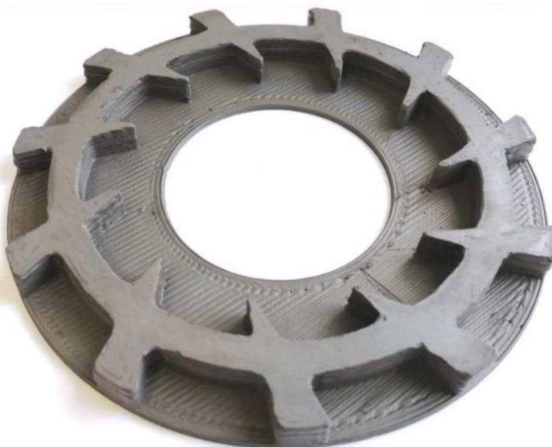
Рис. 1. Заготовка вставки для металлургической отрасли, полученная аддитивным методом экструзии материала (внешний диаметр 200 мм)
