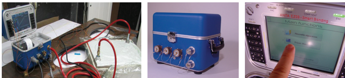
Фото 3. «АНИТА» – пульт для проведения термокомпрессии под вакуумом
