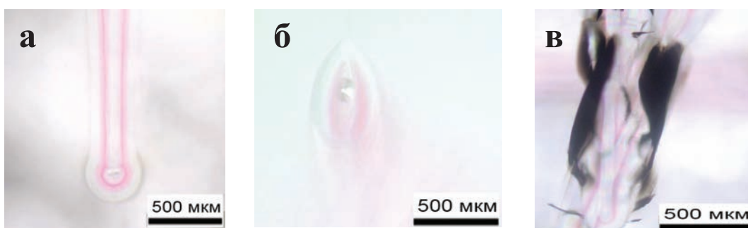
Рис. 2. Продольный (а) и поперечный (б) вид полосы с наночастицами золота.
