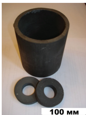
Рис.2. Детали из реакционноспеченного нитрида кремния (RBSN)
