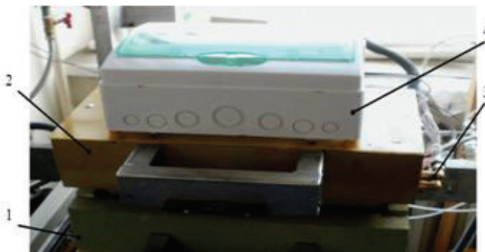
Рис. 2. Установка постформинга: 1 – матрица; 2 – пуансон; 3 – система охлаждения; 4 – блок управления
