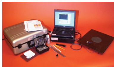
Фото 1. «ЭЛИЗА» – комплект для исследования и анализа повреждений ультразвуком
