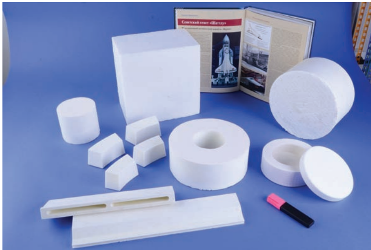
Рис. 1. Изделия из конструкционного теплоизоляционного материала ТЗМ-23М
