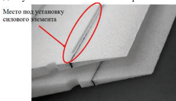
Рис. 3. Заготовки до термообработки (внизу) и после термообработки (вверху)
