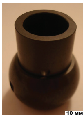
Рис.3. Подшипник скольжения из спеченного нитрида кремния (SSN)
