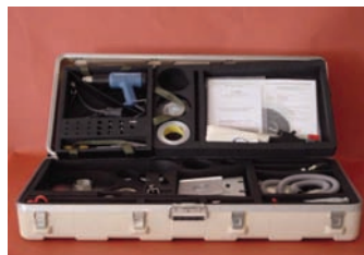
Фото 2. Инструмент и приспособления для удаления поврежденных слоев
