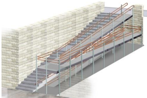
Рис. 1. 3D модель пандусного схода для инвалидов
