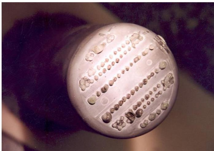
Рис.2. Керамическая фильерная пластина, залитая стеклом после испытаний
