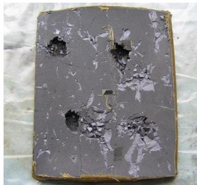
Рис.2. Лицевая сторона монопанели после испытаний
