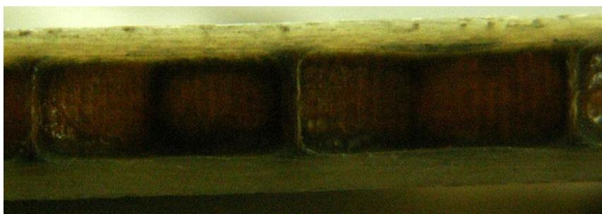
Рис.2. Сечение стенки обтекателя с предварительно подформованными слоями
