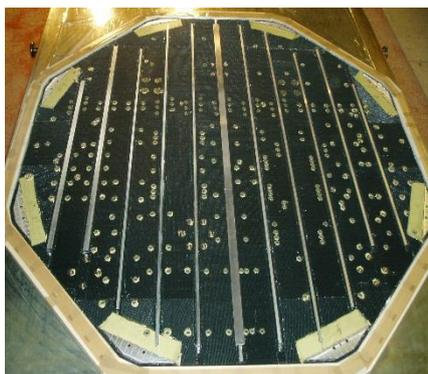
В ОНПП “Технология” разработан способ приклейки ТРП с заданным зазором за единый технологический цикл. Разработан способ контроля качества приклейки ТРП.
