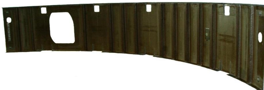
Рис. Секция нижнего отсека третьей ступени ракеты-носителя “Протон-М”
