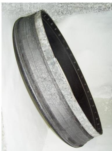
Модельный укороченный крупно-габаритный насадок ЖРД из УККМ с металлокомпозитным переходом
